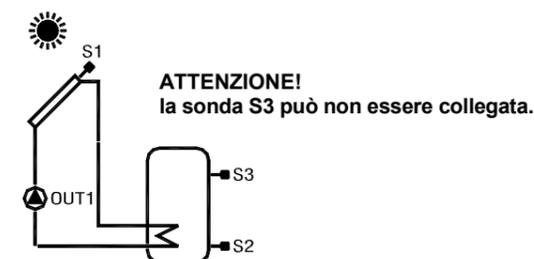
N° 2: Sistema di riscaldamento solare con 1 serbatoio e riscaldamento integrativo incluso.
